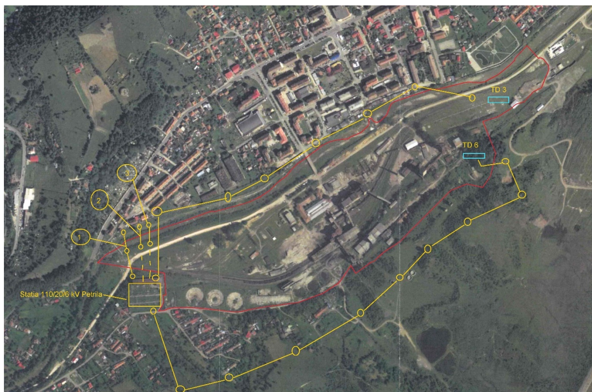
Fig. 2. Linii electrice aeriene (LEA) în zona studiată Sursa: Adresa Rețele Electrice Banat nr. 112653/28.05.2024
